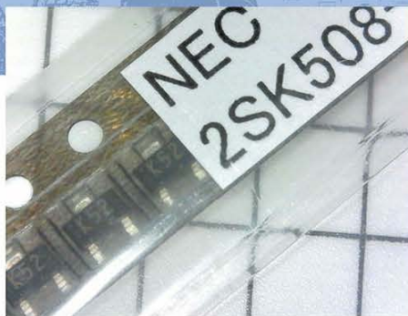
↑写真8／修理のために入手部品した部品、2SK508（静電バック入り）。
