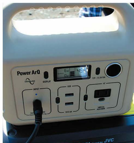
←↑パネルの3面のうち、1面だけ影になる場合(左上)と、2面の半分が隠れる場合(左下)では光が当たる面積は同じでも発電量は全く異なる。右写真では2面を覆ったときの発電量をポータブル電源のモニターで測定。6Wしか発電していない。
