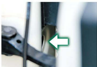
↑写真17／ゴムブッシングを外すと、同軸ケーブルが通りそうなサイズで車内へ引き込みが可能(矢印)。ここから引き込めば同軸ケーブルが外から見えない。
