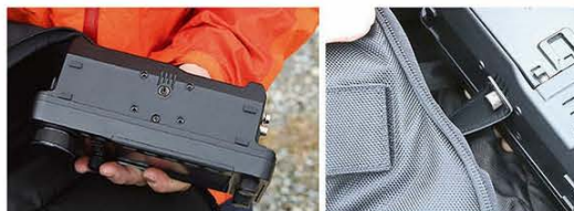
↑マルチバックの上部にIC-705を収納できる。本体底部のネジ穴を利用して、本体をバック内にネジどめする構造。
