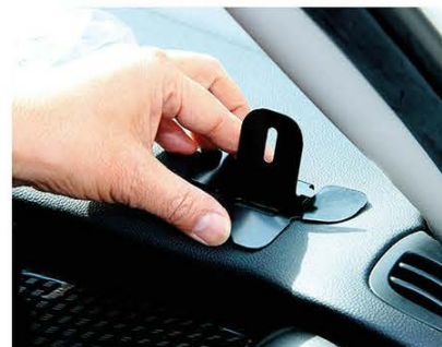
↑写真4/付属のフロントパネル用ブラケットをダッシュボード右側端に設置する。両面テープを剥がし、動かないようにしっかりと固定。
