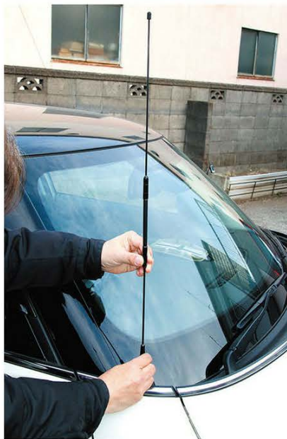
↑写真10／今回ミニクーパーに設置した144/430MHz帯オールインワン貼付けアンテナダイヤモンドZ07M(税込14850円)利得2.15dBi/4.9dBi 全長約70 耐力力60W。
