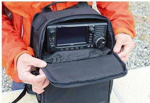
↑IC-705を収納したところ。上部のフタを開けると、無線機の操作ができる。
