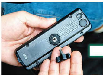
↑写真5/付属のプラスネジは使わず、蝶ネジを使用。これでドライバーが無くても、取り付け、取り外しが可能になった。
