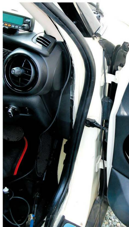
↑写真15／運転席側ドアのウェザーストリップを外し、コントロールケーブルを引き込み、フロントパネルへ接続をする。
