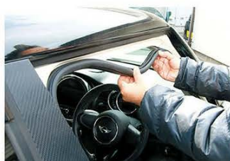
↑写真7/コントロールケーブルを引き込むため、運転席側ドアのウェザーストリップを引っ張って外す。
