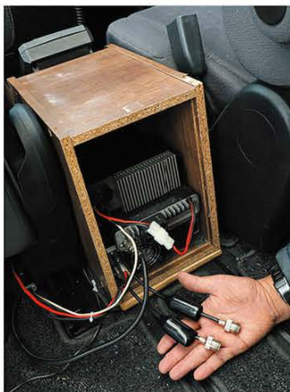
↑TS-480DAT本体からは2本のアンテナコネクタが出ています。アンテナ切り替えでバンドを選択することが可能。そこで、筆者は一方を50MHzに割り当て、50MHzのモノバンドアンテナをつないでいる。
