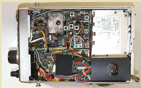
↑写真 6-1 / 発売時期により内部の仕様が異なり、この製品は PIC コントローラー部を取り付けるスペースがない。
