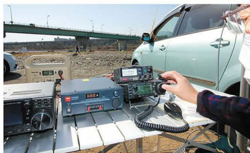
↑テストではポータブル電源からDCソケット→安定化電源を介した使用と、AC出力での使用を比べてみたら、いずれも問題なしだった
