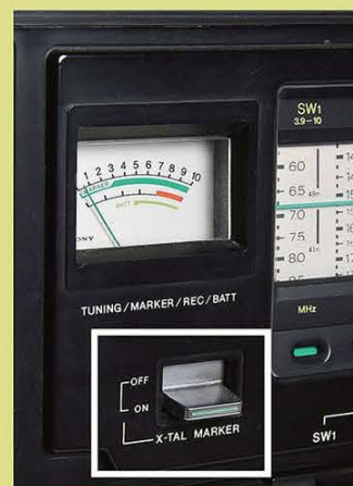
↑大型のスイッチがクリスタルマーカー発振器のスイッチ。ONにすると250kHzごとにマーカー信号が発振される。ダイヤルスケールを目安にメインダイヤルを回していくと、ピーという発振音が聴こえてくる。微調整でゼロビートになるように合わせると、そこがスケール上の目盛りで表示されている周波数だ。
