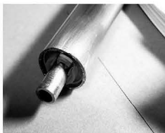
↑写真11/JK1VNN藤間さんのHF帯SMLAの構造。ケーブルブッシングで絶縁している。
