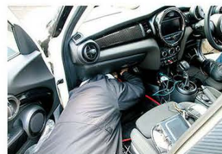
↑写真19／センターコンソール裏にコントロールケーブル、同軸ケーブル、マイクケーブルの3本を通すスペースを確認する。
