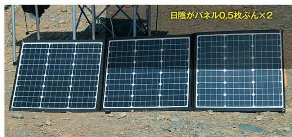
←↑パネルの3面のうち、1面だけ影になる場合(左上)と、2面の半分が隠れる場合(左下)では光が当たる面積は同じでも発電量は全く異なる。右写真では2面を覆ったときの発電量をポータブル電源のモニターで測定。6Wしか発電していない。
