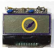
↓写真4/壊れたI2C液晶表面(丸印の部分が損傷)。
