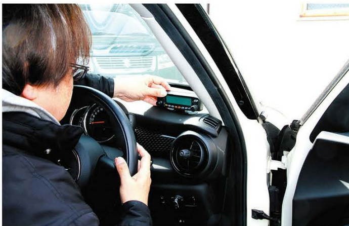
↑写真3/フロントパネルの設置位置を確認中。運転中でも目視や操作がしやすい場所で、安全を確保できる場所に設置をすることが重要。
