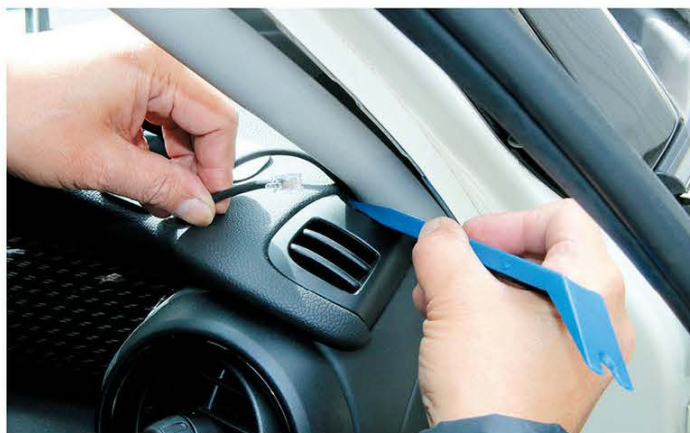
↑写真9/ダッシュボード上部のエアコン吹き出し口と、Aピラーの隙間からコントロールケーブルを引っ張り出す。
