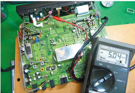
↑写真9/部品交換後、バラック状態で各所の電圧を再度確認。J9-6の電圧を測定すると-5.04Vと適正値に。
