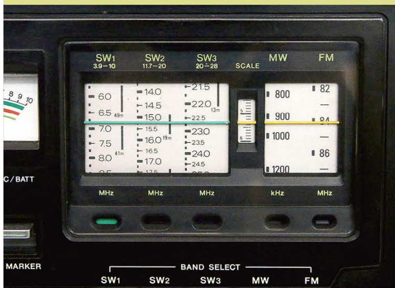
↑白地で見やすいフィルムスケール。スケールはメインダイヤルと連動している。短波帯は250kHzごとに目盛りが振られており、マーカー発振器を活用することでジャストの周波数に合わせられる。
