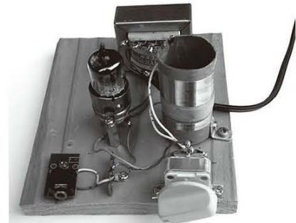
↑写真6／二極管検波ラジオ。木板上に二極真空管（6AL5）、ヒータートランス、アンテナコイル、バリバリコンを取り付けたもの。
