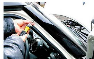
↑写真12／運転席側外装Aピラーは頑丈に取り付けられているので、マイナスドライバーを使ってデコの原理でこじ開けるようにして外すのだ。
