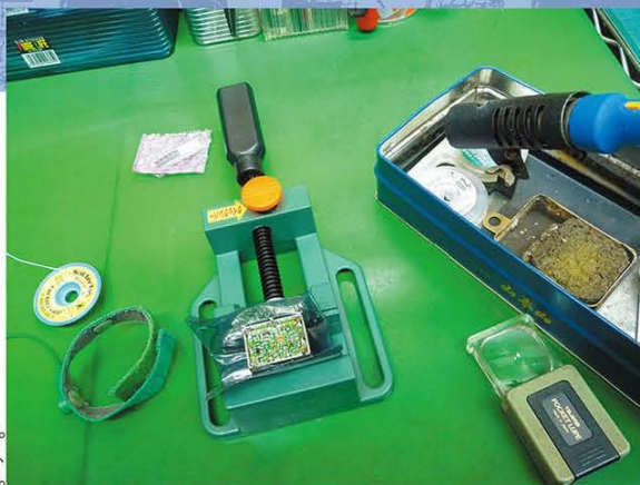
→写真9／FET Q1交換のためのオペを開始。静電気に弱いFETトランジスターを扱うので、静電マットの上で、リストバンド着用で作業する。
