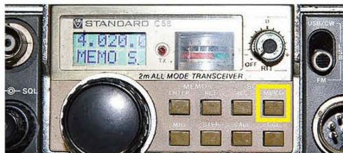
↑写真 8-2 / 操作ボタン SCAN MEMO を押したときの表示。「MEMO S」と表示され、M1～5 にデータがメモリーされていないことを示している。
