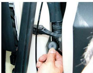
↑写真16／ドアヒンジの奥に何も使っていないゴムブッシングを見つけた。ここから車内に同軸ケーブルを引き込めそうだ。
