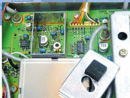
◀写真2 / PLL回路の心臓部、VCO。本機にはVCOが3カ所ある。シールド用のフタを外し、発振周波数をチェックする。3つとも正常に発振していることを確認。
