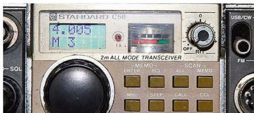
↑写真 8-3 / 操作ボタン SCAN MEMO を押したときの表示。「M 3」を表示しているときは M3 (メモリー No.3) に周波数データがメモリーされている。周波数データがメモリーされていないメモリーはスキップする。
