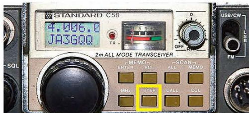
↑写真 8-6 / 操作ボタン「STEP」を押して周波数 5 桁選択したときの表示。
