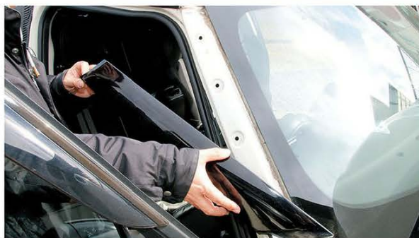
↑写真13／外装Aピラーは3カ所のクリップで固定されている。かなり固く留まっているので慎重に取り外すことが重要だ。
