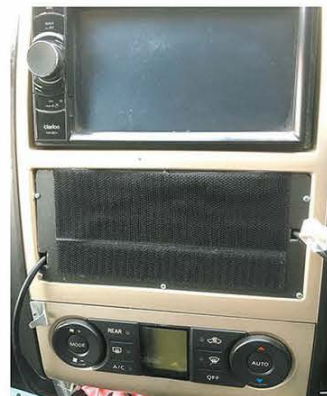
↑上下左右6カ所をビス止めしてから、マジックテープに強力両面テープを貼ってからベースに貼りつける。コントロールユニット側も同様に。
