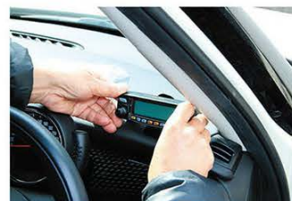
↑写真6/ブラケットにフロントパネルを取り付けた状態。運転中の邪魔にならない位置に設置ができた。
