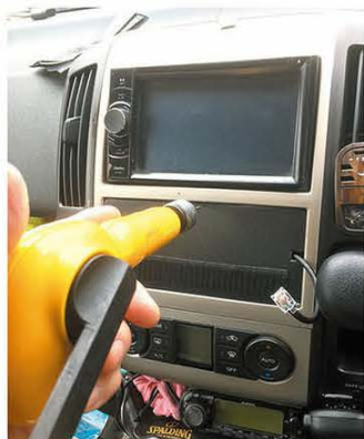
↑ボードの装飾を開始！セパレートケーブルを通してから、細いドリルで隅に穴を開け、ビスでネジ止め。
