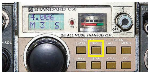
↑写真 8-4 / 操作ボタン MEMO RCL が押されるたびに「M1～M5」が順次切り替わる。下段に「M3」表示中、上段はメモリー (M3) に記憶した周波数データを表示。また、下段「M3」が点滅しているときは、上段にメモリー内に周波数が記憶されておらず、現在使用中の周波数表示。そのとき ENTER を押すと、上段の周波数でメモリーする。
