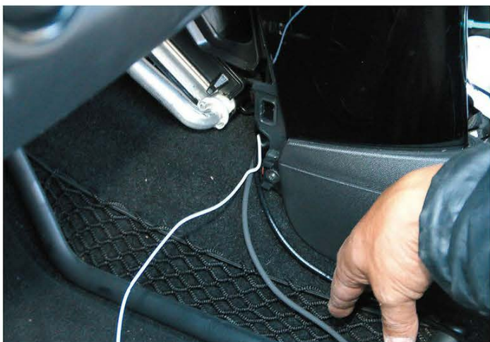
↑写真20／ミニクーバーSのセンターコンソール裏は隙間が少ないため、ガイドワイヤーを通して引き込みスペースを確保するのだ。
