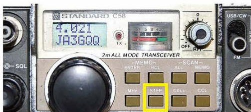
↑写真 8-7 / 操作ボタン「STEP」を押して周波数 4 桁選択したときの表示。
