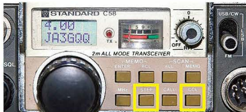
↑写真 8-8 / 電源投入後、または操作ボタン STEP を押して周波数 3 桁表示。MHz ボタンが押されると 144/145MHz 帯に周波数表示が入れ替わる。操作ボタン CCL が押されると写真 8-1～写真 8-5 のいずれかに戻る。
