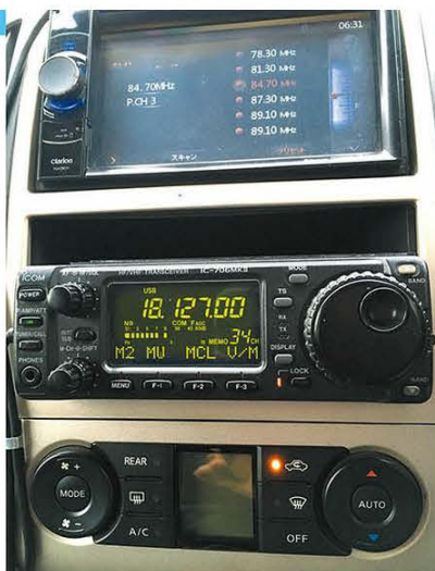
↑宮古島から連れて来たIC-706MKII。最近まで活躍してくれていた。液晶部分は改造しており、標準のものとはネガポジが反転している。
