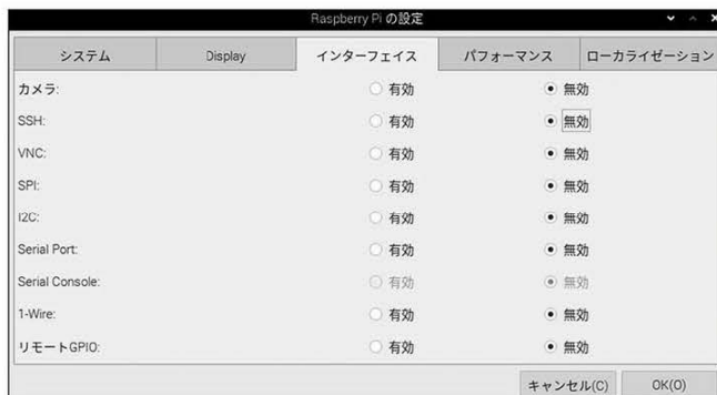
↑写真11/「ラズベリーアイコン」をクリックしてメニュー「設定」を選択後に「Raspberry Pi の設定」をクリック。インターフェースの「SSH:」を「無効」にする。
