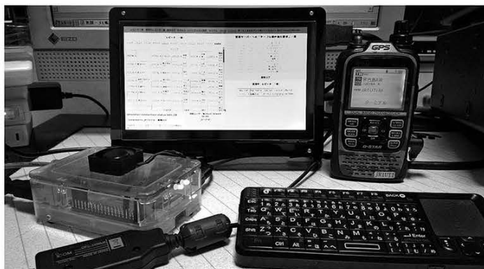
↑写真1/ 機材一式をセットした状態。7インチモニターと超小型マウス付きBluetooth接続キーボードを使用。左の透明ケースの中がRaspberry Pi本体で、受信中にデータの流を確認できるLEDを追加している。左手前が無線機と接続するオプションケーブルのOPC-2350LU。
