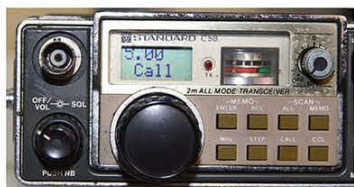
↑写真 8-3 / 操作ボタン SCAN MEMO を押したときの表示。「M 3」を表示しているときは M3 (メモリー No.3) に周波数データがメモリーされている。周波数データがメモリーされていないメモリーはスキップする。
