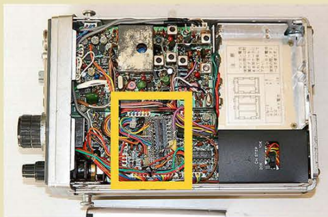
↑写真 5-1 / PIC コントローラー部の半田面を上無線機本体「PLL BOARD」面に取り付け。
