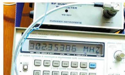
↑写真15／約302MHzの周波数で発振を確認（周波数カウンターの表示参照）。
