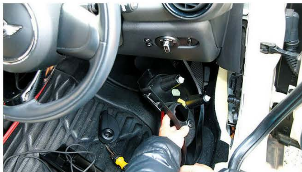
↑写真14／アクセル横の内装パネルを外し、コントロールケーブルとアンテナからの同軸ケーブルを引き込む。
