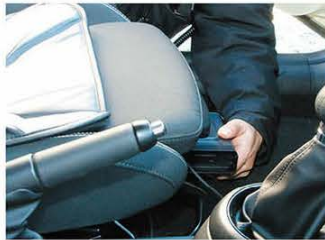
↑写真24／助手席シート下にFTM-100D本体を設置する。本体底面にマジックテープを貼り付け、カーペットに直に取り付けて固定をする。
