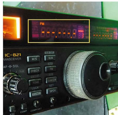
↑写真1/修理依頼に持ち込まれたIC-821を通电、症状を確認する。ディスプレイには周波数が表示されず、「PLLアンロック」の証しである「ドット表示」となっている。
