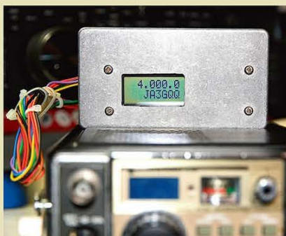
←写真 7-1 / PIC コントローラー部を内部に組み込めないで、表示部を外付けにしたもの。
