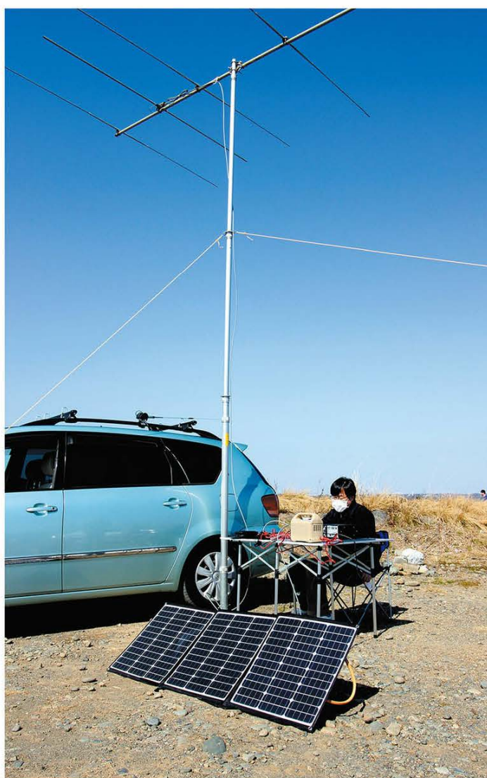
↑今回はソーラーパネルを地面に設置したやり方でテストしましたが、クルマのルーフに設置できるタイプのパネルと車両側のサブバッテリーを組み合わせたい方も面白いと思います。
