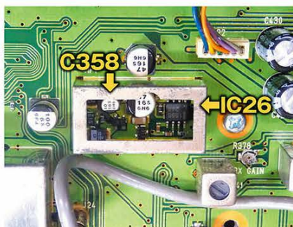
◀写真4 / DC-DCコンバーター部。シールド内にIC26(8ピンSOP)が見える。容量抜けが疑わしかったのが矢印のC358(10μF/16V)。
