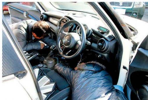
↑写真23／少ない隙間にガイドワイヤーを通すために二人がかりで作業を行う。助手席側から通したガイドワイヤーを運転席側から必死に受け取る。
