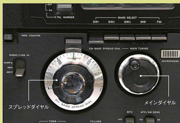
↑メインダイヤルとスプレッドダイヤル。目的周波数の近くまでメインダイヤルを合わせ、クリスタルマーカーで校正後、細かい周波数をスプレッドダイヤルで行う。
