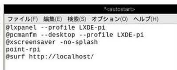
↑写真15/ファイルを右クリックで「Text Editor」で開く。起動時に全画面表示にしない場合は5行目のように書き換える。
