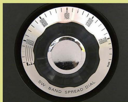
↑スプレッドダイヤルはプラスマイナス140kHz程度の可変が可能。10kHz単位で目盛りが振られており、実質5kHzまで合わせられた。スプレッドダイヤルはギヤ式で、独特の粘りある感触があった。
