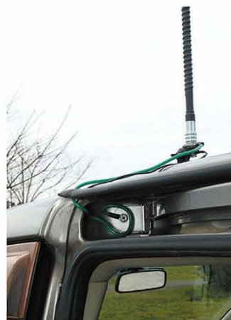
↑アンテナはアースが肝心。筆者はアンテナ基台とボディをグラウンドケーブルでつないで確実なアースとしている。
