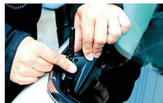
↑写真11／Z07Mは両面テープで貼り付けて設置する。144/430MHz帯共にノンラジアルタイプなので設置場所に困ることは無い。
