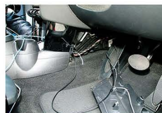
↑写真21／アクセル、ブレーキペダルの動きを妨げないように注意をして配線を行う。運転席足元は事故防止の観点から十分に注意をする。
