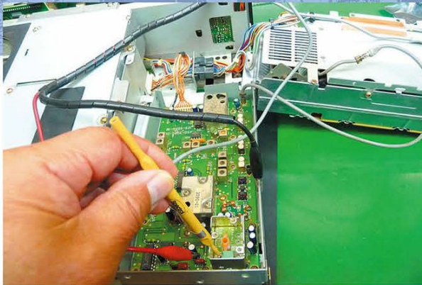
↑写真2/1200MHzモジュールの上半分を外し(写真右上の部分)、モジュール下部にあるCグループ、[Z4] VCOを調整する。
