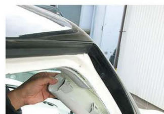
↑写真8/運転席側内装Aピラーを天井側に引き上げながら引っ張り外す。かなり力を入れないと外れないので諦めず引っ張る。
