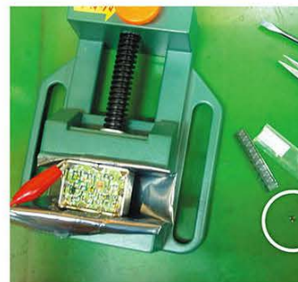
↑写真12／部品は右下の黒い点（円で囲んだ部分）。こんなに小さいものを、部品でびっしりの基板に半田付けしなければならない！ 赤いミニムシクリップは、アース用。
