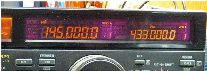
↑写真11/正常に周波数を表示、送受信が可能になったIC-821。
