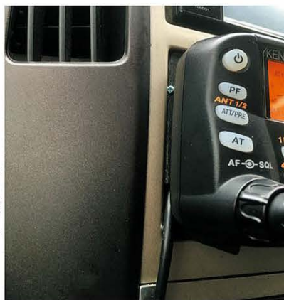
↑上下左右6カ所をビス止めしてから、マジックテープに強力両面テープを貼ってからベースに貼りつける。コントロールユニット側も同様に。
