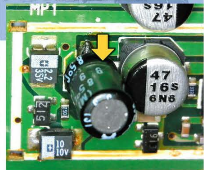
↑写真8/チップ部品に交換せず、一般の電解コンデンサーに交換した (矢印)。背が高いので、スペースに収まるかの確認が必要。
