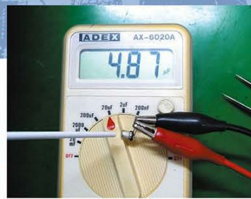
↑写真7/外した電解コンデンサーの静電容量を測定したところ、実測で約5μF。容量抜けの状態であることを確認。
