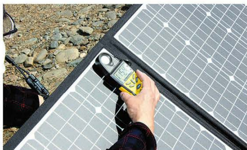
↑私物の簡易照度計で照度を測定。真夏と比べるとさすがに照度は落ちるが、それでも真夏の照射の半分程度の照度は確保できている
